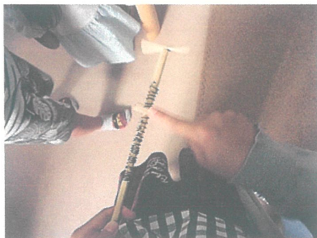
巻いた針金の上をこすると、プロペラが回ります。 「え、どうして?」「振動でまわるんだって」
